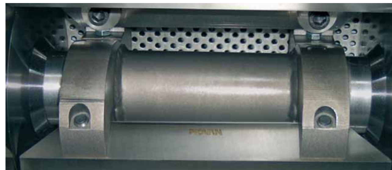
(a) Camera di granulazione con dischi laterali rotanti combinati con il rotore per evitare attrito e deformazioni del materiale da granulare
