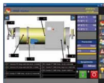
Il comando touchscreen ad uso intuitivo visualizza le condizioni attuali di lavoro e offre facile accesso ai parametri macchina/processo. È possibile controllare il processo completo: alimentazione del materiale, deumidificazione IR, deumidificazione profonda post-processo.
