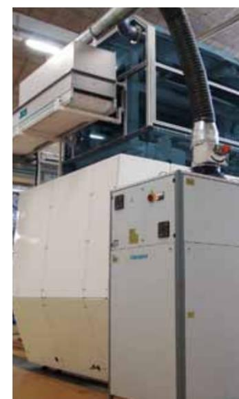
Per evitare la formazione di condensa sulle cavità dello stampo e sulla superficie al variare delle condizioni ambientali, un flusso di aria secca viene soffiato all'interno della zona stampo.
