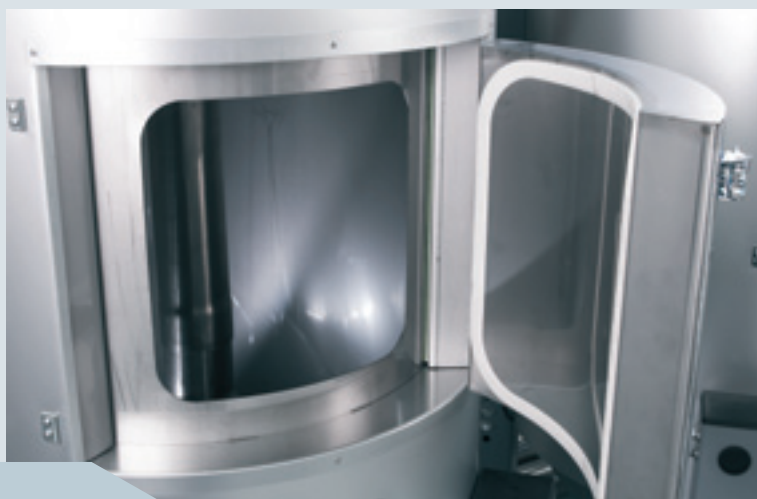
Particolare dell'apertura della tramoggia
